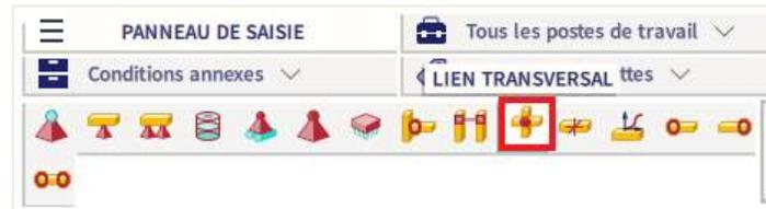
Lorsque deux poutres sont connectées par cette option, dans la fenêtre « Longueurs de référence et paramètres de flambement » des deux éléments, vous pouvez définir les « Diagonales en croix » dans les types de systèmes spéciaux (cette option se trouve dans la « Configuration avancée ») :
