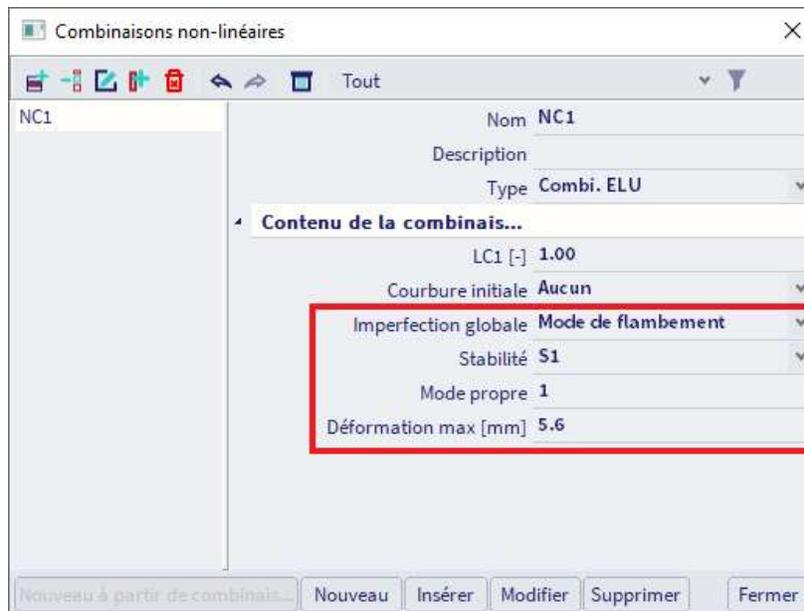
La dernière option à saisir est la déformation maximale. Il s'agit de la déformation du nœud la plus importante de la structure. SCIA Engineer recalculera tous les déplacements des autres nœuds en utilisant cette déformation maximale.
